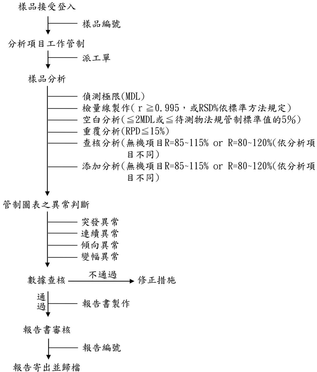
圖 1.5-2 品保/品管作業流程圖
